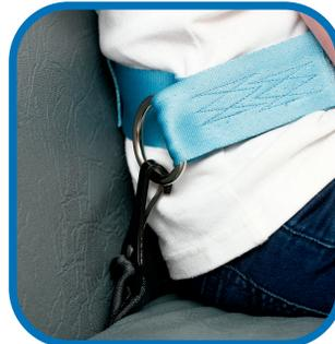
5. Une fois le passager correctement assis (les hanches basses contre le dossier du siège et les épaules au même niveau que le siège), fixez les crochets d'attache aux anneaux en D au niveau des hanches.
