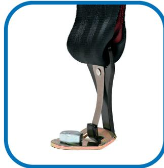
2. Fixez (2) crochets d'attache, auxquels sont reliées les sangles bordeaux et noires, aux kits de fixation d'attache installés.
