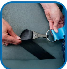
9. Fixez les crochets d'attache au niveau des hanches aux anneaux en D au niveau des hanches sur le gilet.
