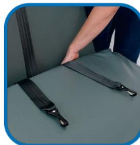
3. Fermez le siege de l'autobus. Si votre siege est equipe d'une barre transversale, il est essentiel d'effectuer cette etape avant de serrer la sangle afin qu'elle puisse manoeuvrer autour de la barre et assurer une fermeture correcte. Laissez les crochets d'attache au niveau des hanches s'etendre sur le siege de l'autobus.
