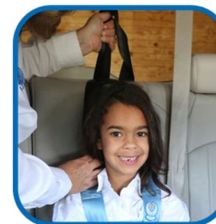
6. Réduisez le mou de l'attache en soulevant le dispositif de réglage de verrouillage d'inclinaison vers le haut. Faites glisser la sangle pour la desserrer ou la serrer.
