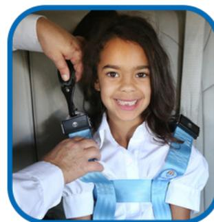
5. Une fois le passager correctement assis (les hanches basses contre le dossier du siège et les épaules au même niveau que le siège), fixez chaque mousqueton à l'extrémité du « Y » aux fentes d'attache des dispositifs de réglage des épaules.
