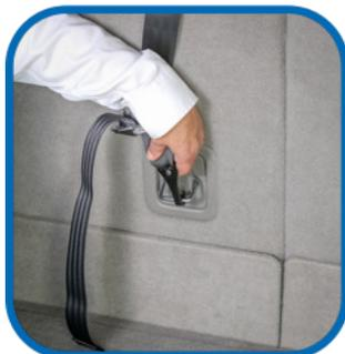
2. Fixez le mousqueton du support d'attache à l'ancrage d'attache de la voiture.
