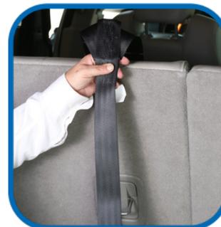
3. Placez le « Y » du support d'attache sur le dossier du siège.
