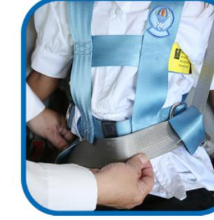
8. Bouclez la ceinture en bas sur les genoux. Fixez la ceinture de sécurité aussi fermement que possible. Assurez-vous que la ceinture de sécurité est en position verrouillée.
