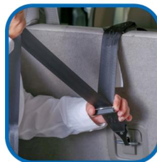
4. Serrez la sangle en tirant la sangle à travers le dispositif de réglage de verrouillage d'inclinaison.
