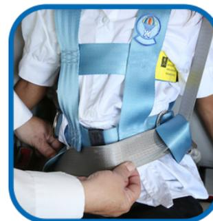
8. Abroche el cinturon en la parte baja del regazo. Asegure el cinturon de seguridad lo mas apretado posible. Asegurese de que el cinturon de seguridad este en una posicion bloqueada.
