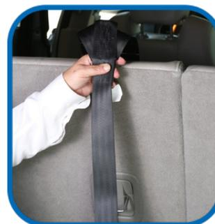
3. Coloque la "Y" del soporte de sujecion sobre el respaldo del asiento.
