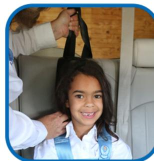
6. Reduzca la holgura de la sujecion levantando el ajustador de bloqueo de inclinacion hacia arriba. Deslice la cinta para aflojar o apretar.
