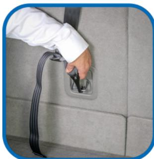
2. Fije el gancho de resorte del soporte de sujecion al anclaje de sujecion del automovil.
