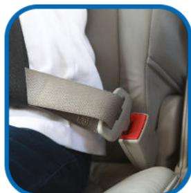
7. Abroche el cinturón de seguridad en la parte baja del regazo y reduzca la holgura del cinturón. Asegurese de que el cinturón de seguridad este en la posición bloqueada.
