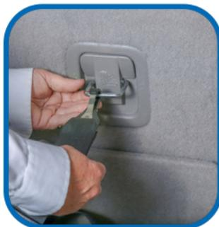
2. Conecte el gancho de la correa de sujecion al soporte de anclaje de la correa de sujecion directamente detras del pasajero.
