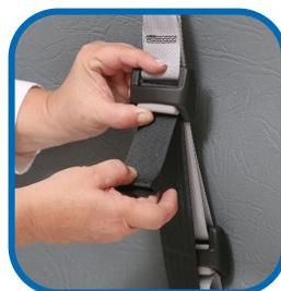
15. Appuyez sur l'ajusteur a verrou a ressort derriere le siege. Tirez sur le noir extremite de la sangle pour ajuster.
